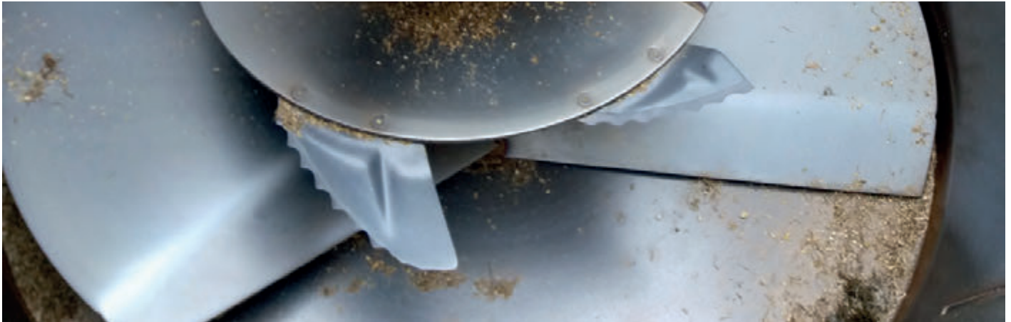
Ein Blick in den Mischwagen lohnt sich fast immer! Sind die Messer stumpf? Gibt es Mischschatten?
